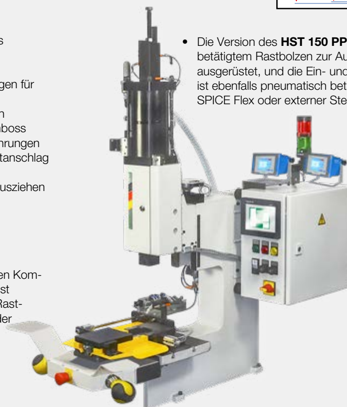
HST 150 PPR in Arbeitsstellung mit pneumatisch betätigtem Rastbolzen mit pneumatisch betätigter Ein- und Ausfahrbewegung
