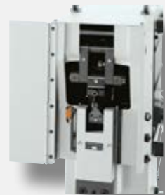
Verstellbares Gelenkstück zur Feinverstellung des Pressenstößels. Verstellbereich: 16 mm
