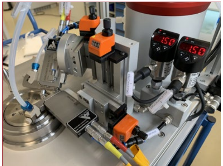
Mikrodosiersystem zur Schmierung verschiedener Schrauben
