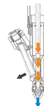
Der Schrauber steht bereits direkt vor dem Produkt in Startposition. Der Schraubendreher fährt vorwärts in Richtung Schraube und bewegt den Schwenkarm zur Seite, in Parkposition.
