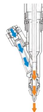
Während der Schraubendreher die Schraube eindreht, kann die nächste bereits in den Schwenkarm eingeschossen werden, obwohl dieser sich noch in der Parkposition befindet. Das spart Zeit.
