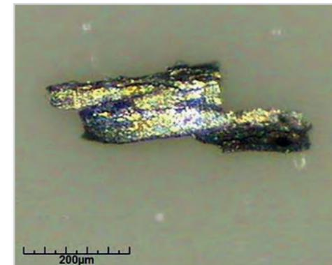
Metallischer Partikel aus dem Schraubengewinde
